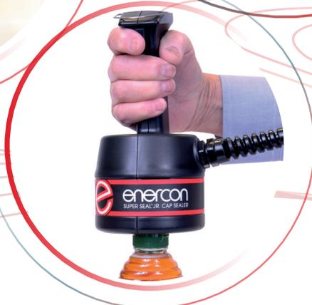
Le récipient est rempli et fermé par un bouchon (équipé d'un opercule). Puis, le récipient passe sous la thermoscelleuse par induction où un champ électromagnétique contrôlé transfère l'énergie à l'opercule dans le bouchon, créant de la chaleur.
